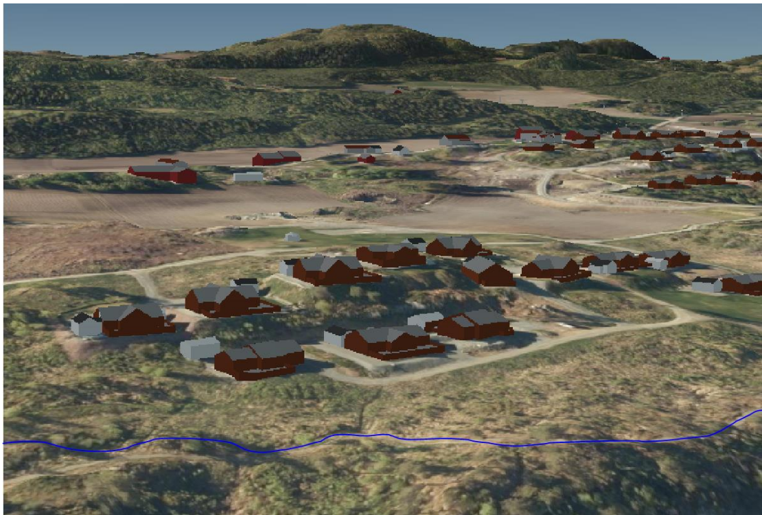
3D-modell av del av Fånestangen hytteområde (felt BFR5). Figuren viser flyfoto drapert over en høydemodell med påsatte byggevolum. Bildet gir ikke riktig inntrykk av høyde på vegetasjon eller bygningenes visuelle uttrykk og farger. Frostastien er markert med blå stripe nederst.
