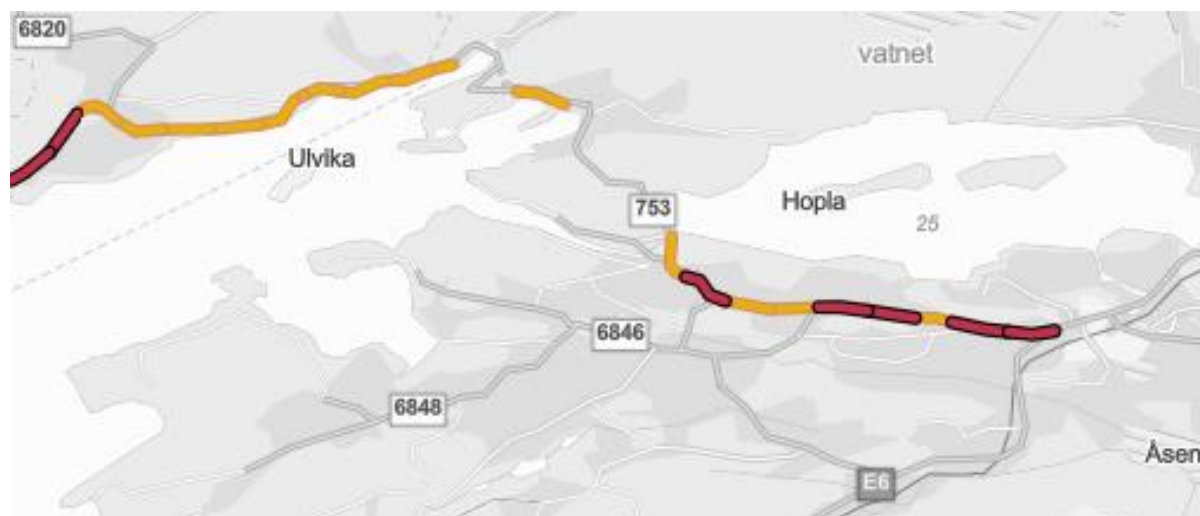
Figur 18: Dekkebredde under 6,5 m vist med gul linje, under 6 m med rød linje (GIS-visning)
